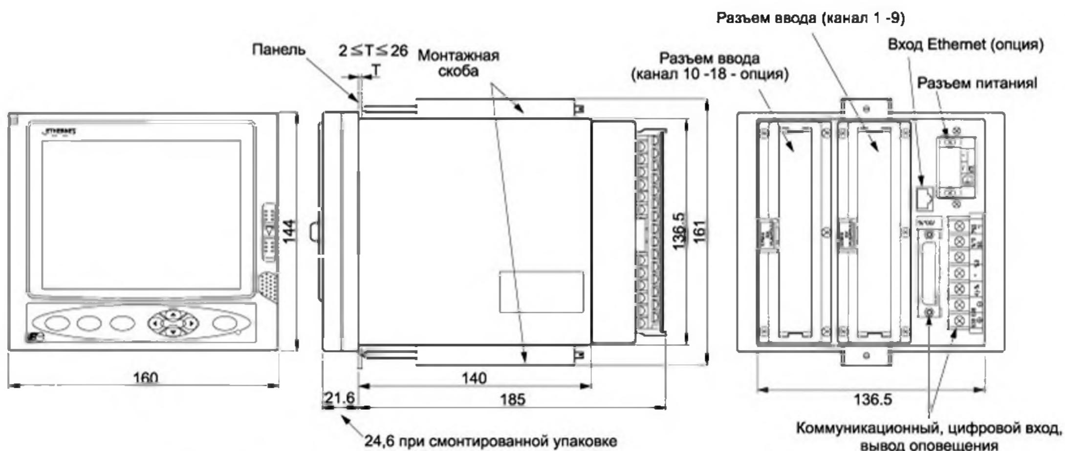
(Примечание) при монтаже прибора рядом с полом или нескольких приборов рядом друг с другом необходимо оставлять между ними зазор не менее 100 мм.
